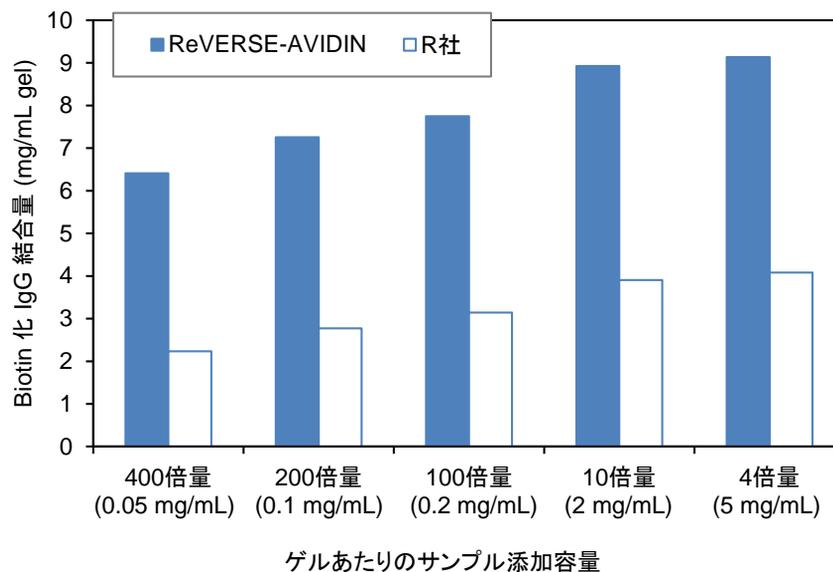
ReVERSE-AVIDIN ゲル10  $\mu$ Lに、4倍量から400倍量のBiotin 化 human IgG を 20 mg/mL gel の量で添加し、室温で1時間振とう後、5 mM Biotin-PBS で溶出した。ReVERSE-AVIDIN は、サンプル添加容量の増加に伴う結合量の低下が他社品よりも小さく、400 倍量では、4 倍量の 75% の結合量であった。一方、他社品は、400 倍量で 54% の結合量であった。4 倍量で他社品の 2.2 倍、400 倍量で 2.9 倍の結合量となった。
