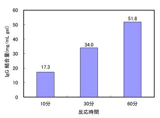
ヒト IgG 溶液 25 倍量 を Ab-Capcher Mag に 50 mg/mL gel 相当量添加し、抗体精製量とその捕捉率に対する反応時間の効果を調べた。その結果、反応時間を長くすることで収量は増加し、1時間で82%、2時間で89%の収量となった。さらに収量を上げたい場合は一夜静置  $(4^{\circ}C)$ することで 90%以上の IgG を回収することができた。次にマウス血清からの抗体精製量に対する反応時間の効果を調べたところ、マウス抗体についても反応時間を長くすることで精製量は増加し、1時間の反応で 51.8 mg/mL gel の IgG を精製することができた。
